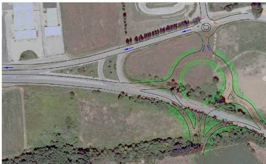
*Schema proposto di assetto del nodo, con l'inserimento della rotatoria minore*
