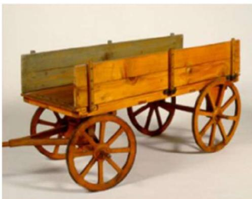
Il *Carrus*, era un carro dotato di quattro ruote ed otto raggi, era destinato al trasporto di merci, di derrate e a trasporti militari; era dotato di un lungo pianale con sponde destinate a tenere fermo il carico. Poteva sostenere un carico fino ad un massimo di circa 20 quintali.
